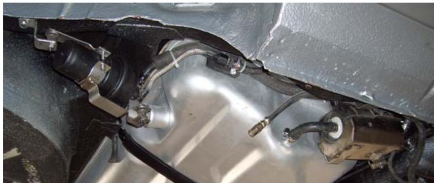
1 Druckspeicherhalter aus Edelstahl inkl. den 2 Haltebügeln komplett mit Schwinggummis einbaufertig zusammengeschraubt. Inklusiv Befestigungsschrauben.
